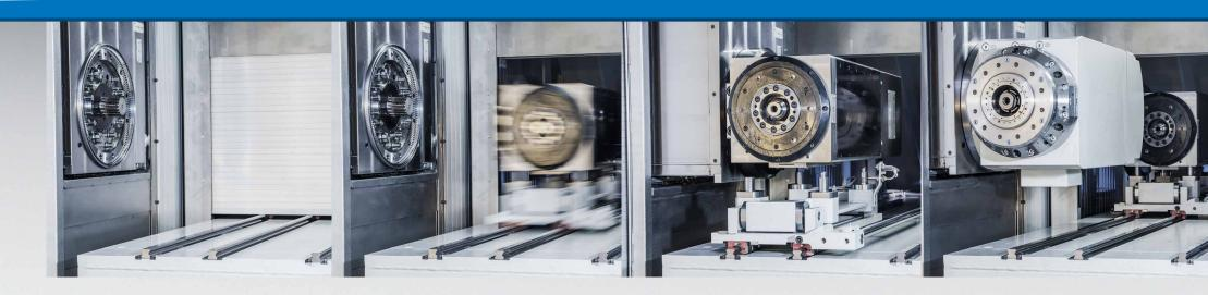
製造時間とコストを節約し、生産性を最大化するために、mpmc は最小限のセットアップ数でワークピース全体を完成させることができます。通常、いくつかの異なる機械で処理されるすべての加工業務を遂行する能力を有しており、高い汎用性があります。
